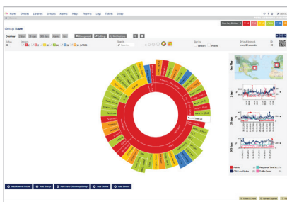
ABBILDUNG: Der Sunburst View von PRTG bietet einen schnellen Überblick über den Zustand des Netzwerks.
